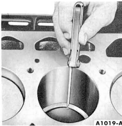
FIG. 42—Piston Ring Gap
