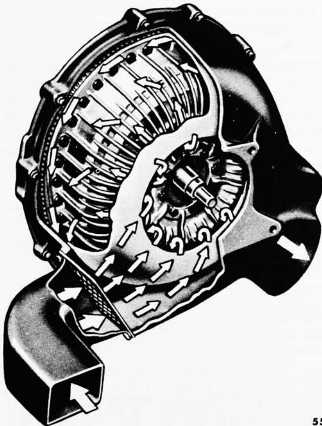
Fig. 3—Converter Cooling Diagram—Car
