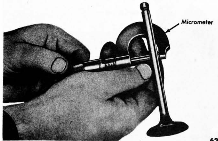
Fig. 11—Measuring O. D. of Valve Stem
